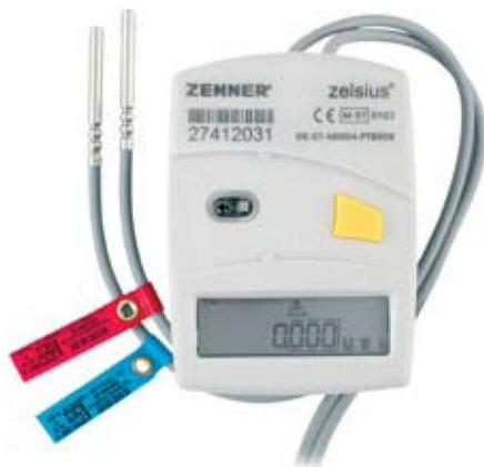
Contorul de energie termică este utilizat pentru înregistrarea energiei consumate pentru încălzirea pe orizontală a apartamentelor în cadrul unui imobil. Facturarea încălzirii se poate face direct după indexul preluat de la contorul de energie termică compact montat individual.
